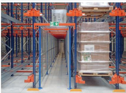
**Mecalux hat das Lager des Logistikunternehmens Weddeling GmbH in Borken (Deutschland) mit zwei Regalblöcken mit dem halbautomatisierten Pallet Shuttle-System ausgestattet. Dank dieser Lösung, die Platz für 4876 Paletten bietet, profitiert das Unternehmen von der schnellen Ein- und Auslagerung der Ware aus den entsprechenden Kanälen.**
