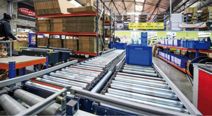
Behälterfördersysteme sind Transportelemente, die Entfernungen innerhalb eines Lagers überbrücken. Das französische Autoersatzteilunternehmen C.D.A.L. hat in seinem Vertriebszentrum in Saint Priest in Südfrankreich einen Förderkreislauf montiert, der das Lager auf automatische Weise mit dem Versandbereich verbindet.
