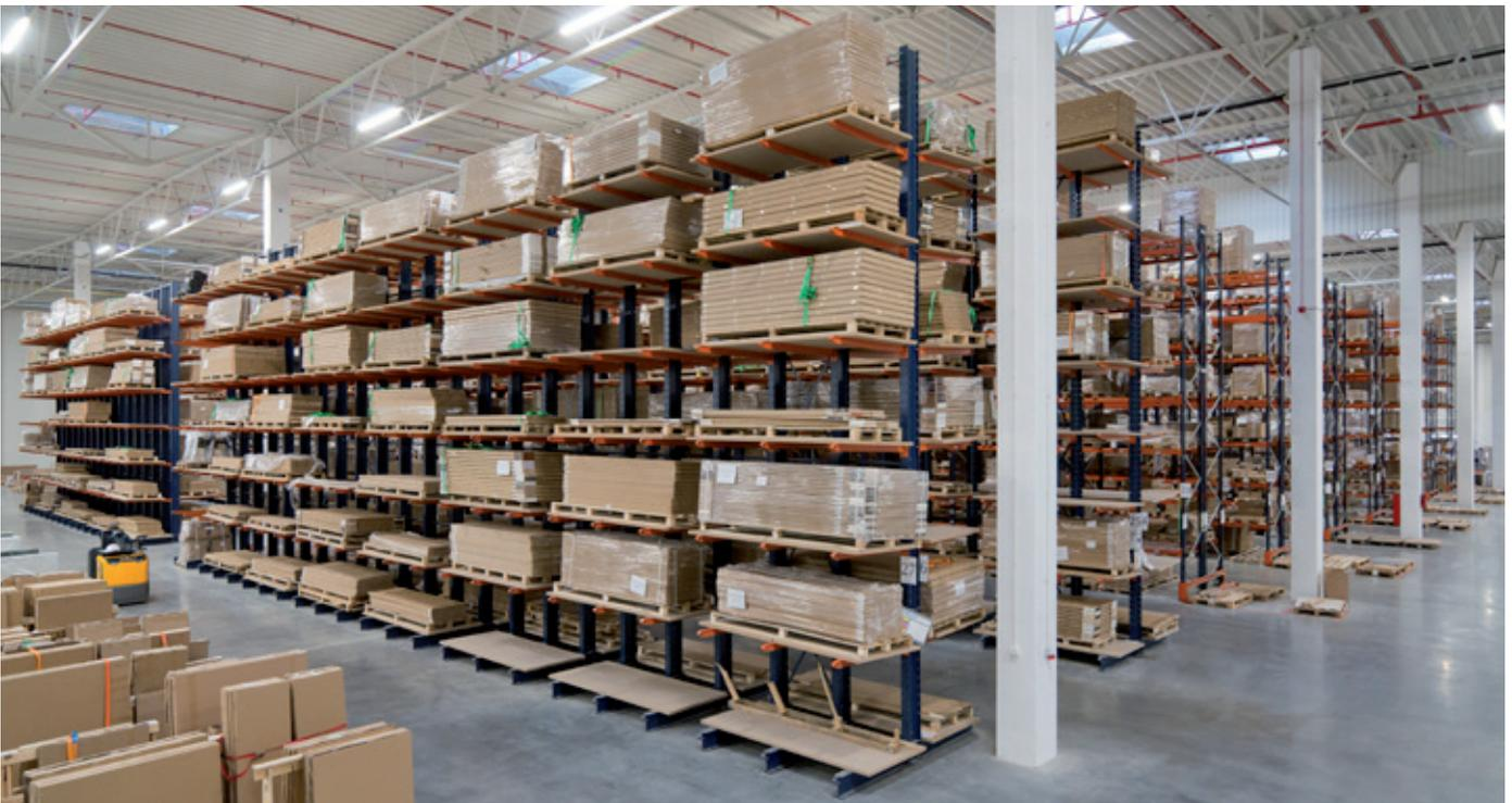
MYCS hat sein neues 12.748 m<sup>2</sup> großes Logistikzentrum in Stettin (Polen) mit Palettenregalen und Kragarmregalen von Mecalux ausgestattet. Die beiden Lagerlösungen zeichnen sich durch ihre Flexibilität aus, da sie sich an die Abmessungen der Produkte (Bestandteile von Möbeln wie Tischen, Regalen oder Schränken) anpassen lassen. Durch den direkten Zugriff auf die Waren beschleunigen sie außerdem die Warenverwaltung und unterstützen die Bestandskontrolle.
