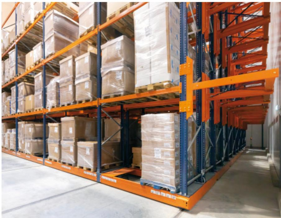
Movirack-Verschieberegale eignen sich besonders gut für den Einsatz in Tiefkühlagern wie dem von Sabarot, da sie durch die optimale Verteilung der Kälte zwischen den Paletten den Energieverbrauch verringern
