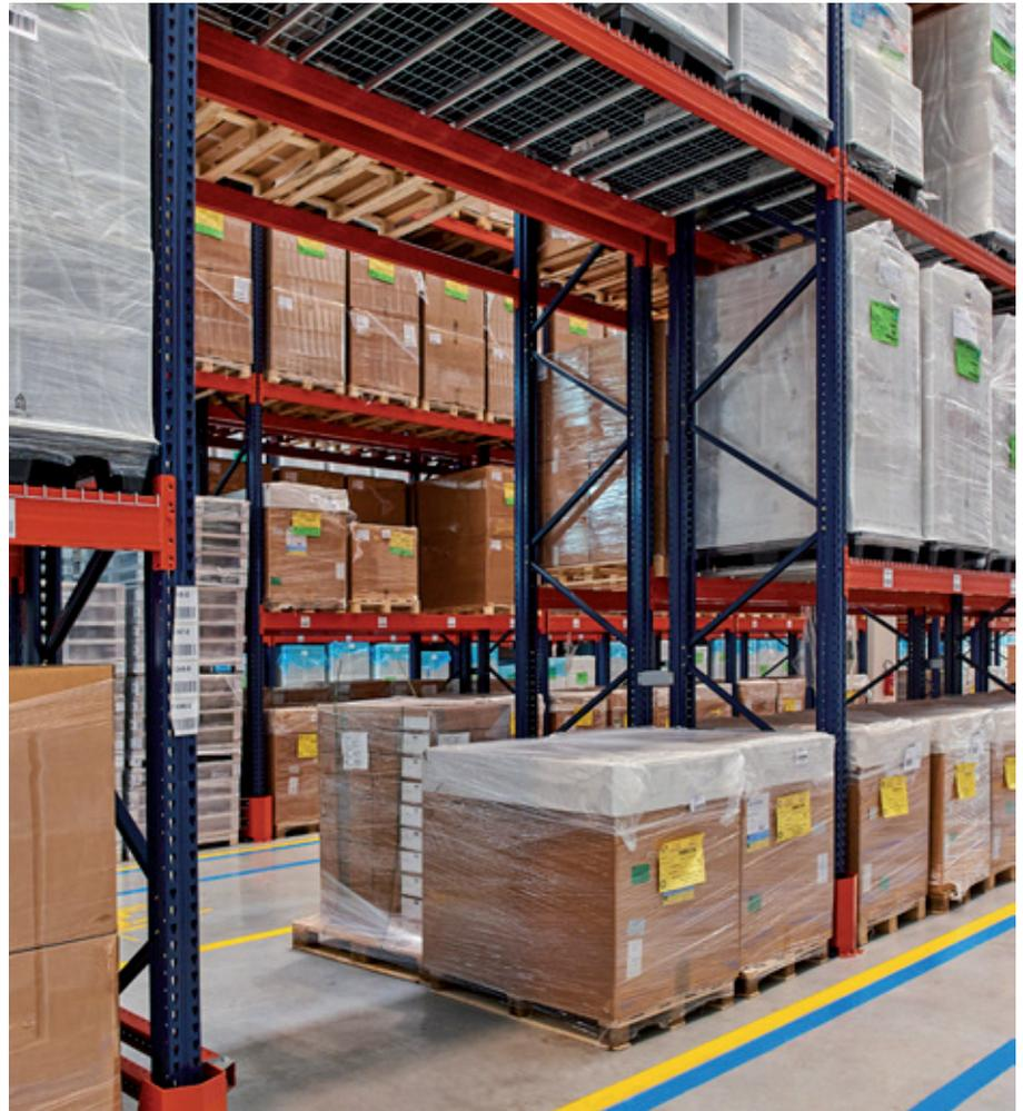
Die Gitterfachböden gewährleisten die Stabilität der Lasten und verhindern ein unbeabsichtigtes Herunterfallen der Produkte
