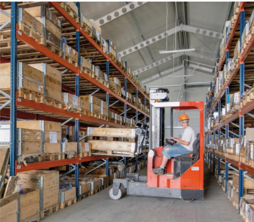
**Das Metallprofilager von MetalERG besteht aus konventionellen Palettenregalen und Kragarmregalen. In beiden Systemen können Produkte mit verschiedenen Abmessungen und Eigenschaften gelagert werden, und beide bieten einen direkten Zugriff auf die Ware, wodurch die Lagerarbeiten und die Auftragszusammenstellung beschleunigt werden.**
