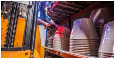
Die Regalanlage mit engen Gängen optimiert die verfügbare Fläche des Lagers, um eine höhere Lagerkapazität zu erzielen
