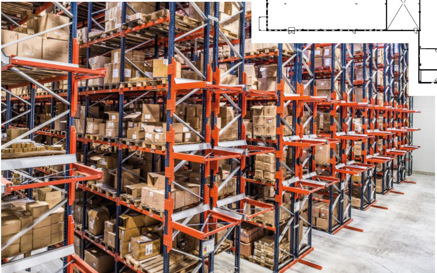
Einer der Bereiche besteht aus engen Gängen, daher wird dort mit Hochregalstaplern gearbeitet. Zur Kommissionierung werden ebenfalls in der Höhe arbeitende Kommissionierstapler eingesetzt.
