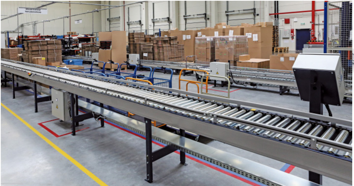
Die Behälter werden mithilfe eines 38 m langen Förderkreislaufs zu den Kommissionierstellen gebracht
