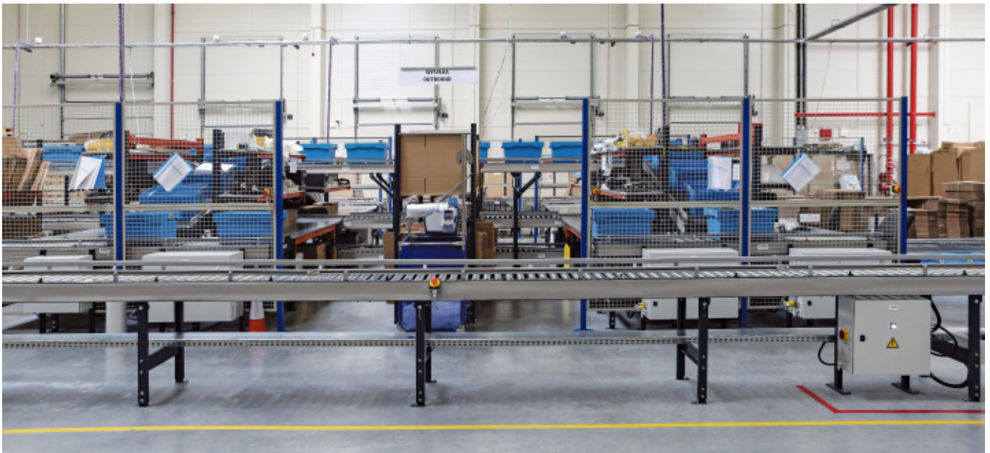
Die Behälter werden mithilfe eines 38 m langen Förderkreislaufs zu den Kommissionierstellen gebracht
