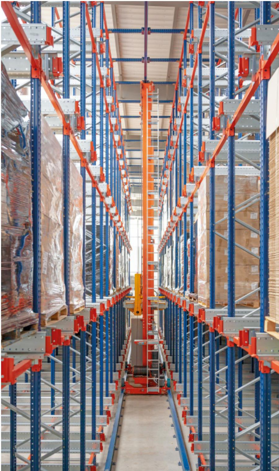
unter Berücksichtigung der Anzahl der leeren Positionen, der Artikelart und der Nachfrage eine Reihe von Berechnungen durch, um eine Lagerposition in den Regalen zuzuweisen. An diesem Punkt kommt die Robotisierung zum Einsatz und das Regalbediengerät und der Pallet-Shuttle-Wagen transportieren die Palette mithilfe von Fördervorrichtungen automatisch zu der entsprechenden Lagerposition.
