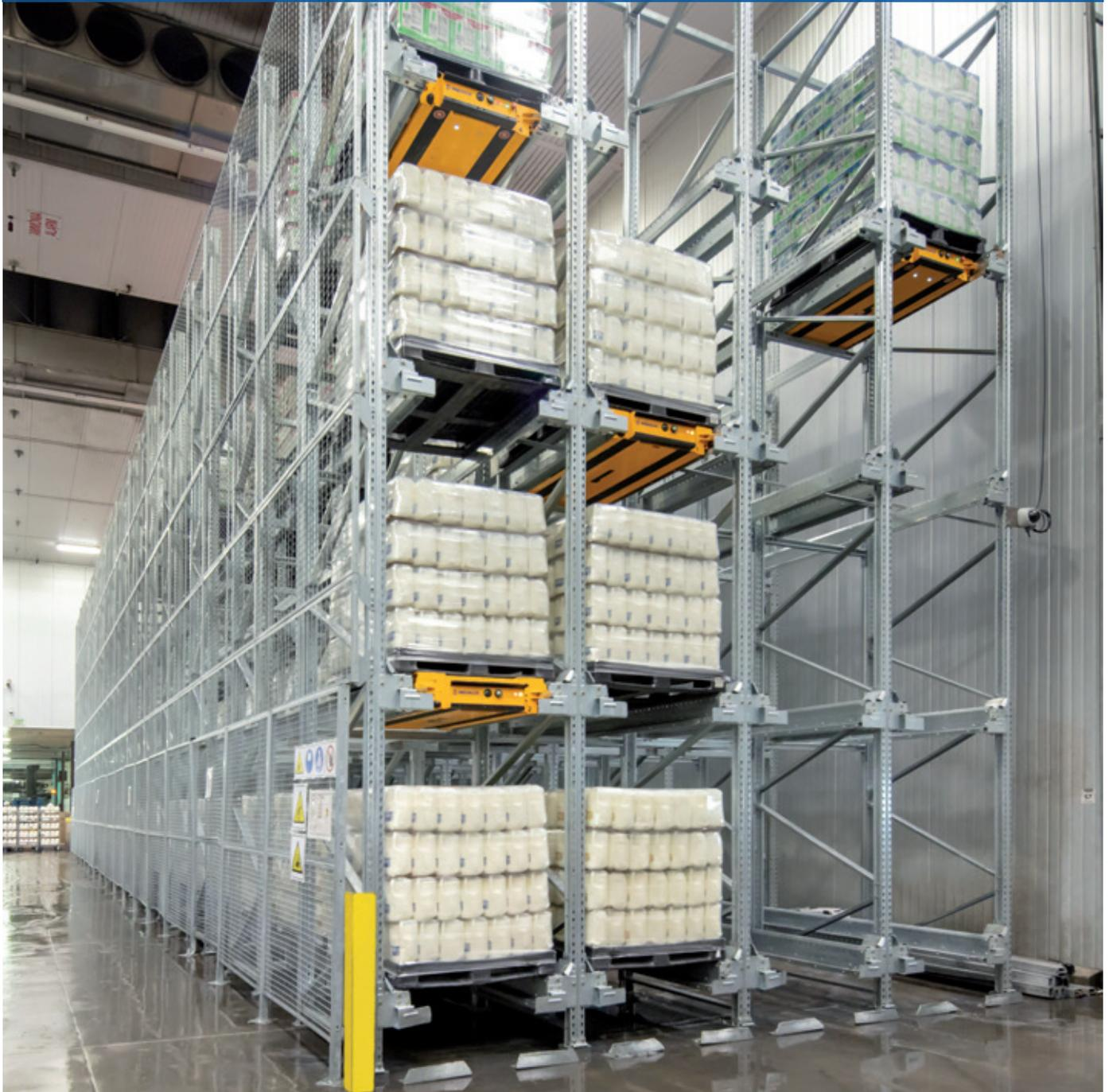
Der Lieferant und Vertreiber von Molkereiprodukten Producers Dairy hat sein 4.645 m<sup>2</sup> großes Kühlager in seiner Produktionsanlage in Fresno (Kalifornien) mit dem halbautomatischen Pallet-Shuttle-System von Interlake Mecalux ausgestattet. Die Firma hat ihre früheren Palettenregale, die veraltet waren, durch das Pallet-Shuttle-System ersetzt. Dank dieser Lösung hat das Unternehmen die Lagerkapazität verdoppelt und kann jetzt bis zu 300 Aufträge pro Tag zusammenstellen.
