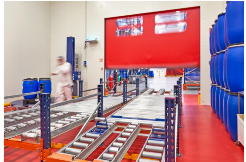
**Durchlaufregale begünstigen einen sicheren Warentransfer vom Lager bis zu den Produktionslinien**
