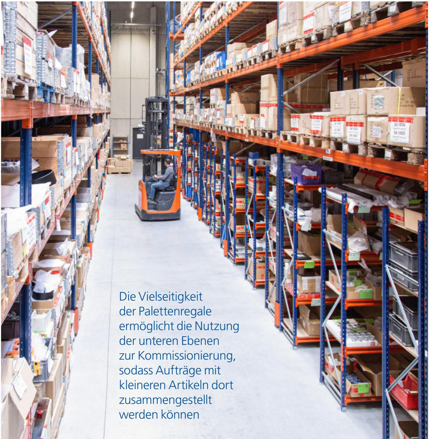
Die Vielseitigkeit der Palettenregale ermöglicht die Nutzung der unteren Ebenen zur Kommissionierung, sodass Aufträge mit kleineren Artikeln dort zusammengestellt werden können
