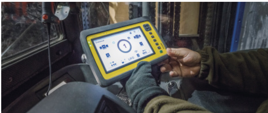
Der Staplerfahrer übermittelt die Anweisungen zur Ein- und Auslagerung mithilfe eines für kalte Arbeitsumgebungen ausgelegten Tablet-PCs mit WLAN-Verbindung an den Wagen.
