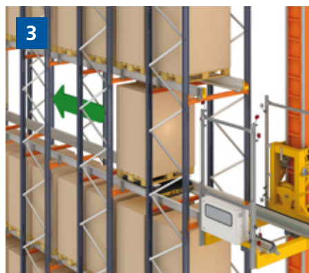
3. Der automatische Wagen hebt die Ladung etwas an und setzt sie in den Lagerkanal. Er bewegt sich mit der Palette bis zur ersten freien Lagerposition, wo er sie absenkt und auf die Schiene setzt.
