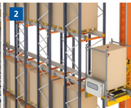
2. Das Regalbediengerät holt die Palette mithilfe von im Schlitten vorhandenen Ketten ab und fährt zu dem vom LVS zugewiesenen Kanal.
