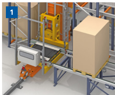
1. Das Pallet Shuttle im Schlitten des Regalbediengeräts wartet auf die Ankunft der Palette aus der Kontrollstation.
