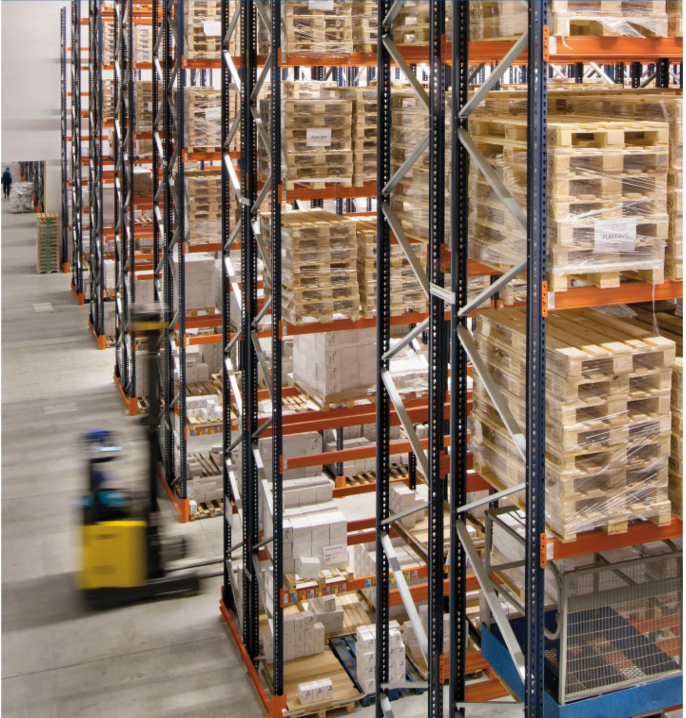
Das neue Lager von Ziaja, einem polnischen Hersteller von Naturkosmetik und natürlichen Arzneimitteln, wurde speziell zur Beschleunigung der Kommissionierung entworfen. Mecalux hat die herkömmlichen Palettenregalanlagen installiert, die einen direkten Zugang zur Ware ermöglichen und eine Lagerkapazität für 10.906 Paletten haben.
