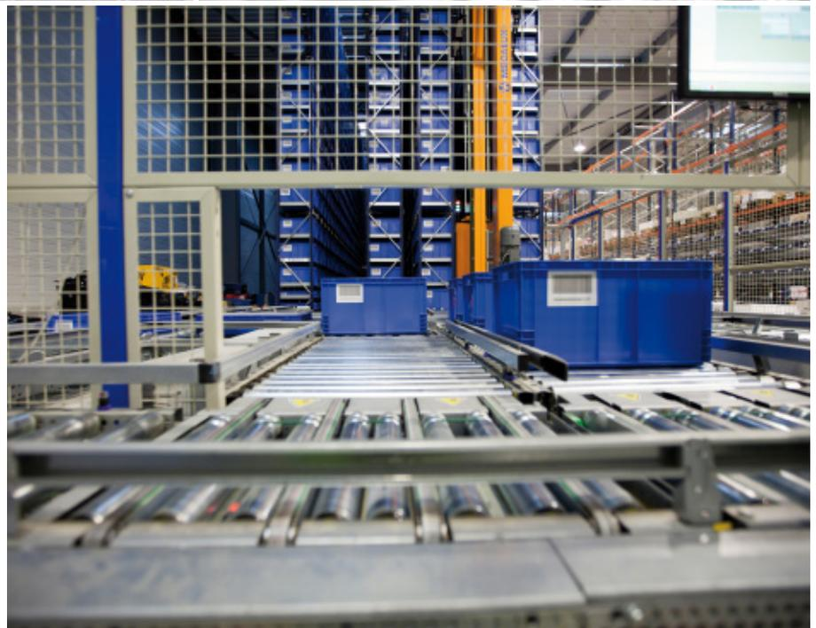
Das Miniload-Lager eignet sich zur Lagerung von 5320 Eurokisten zu 600 x 400 x 120 / 320 mm und erreicht mit der Erweiterung um einen Gang, ein Fassungsvermögen von 7980 Eurokisten
