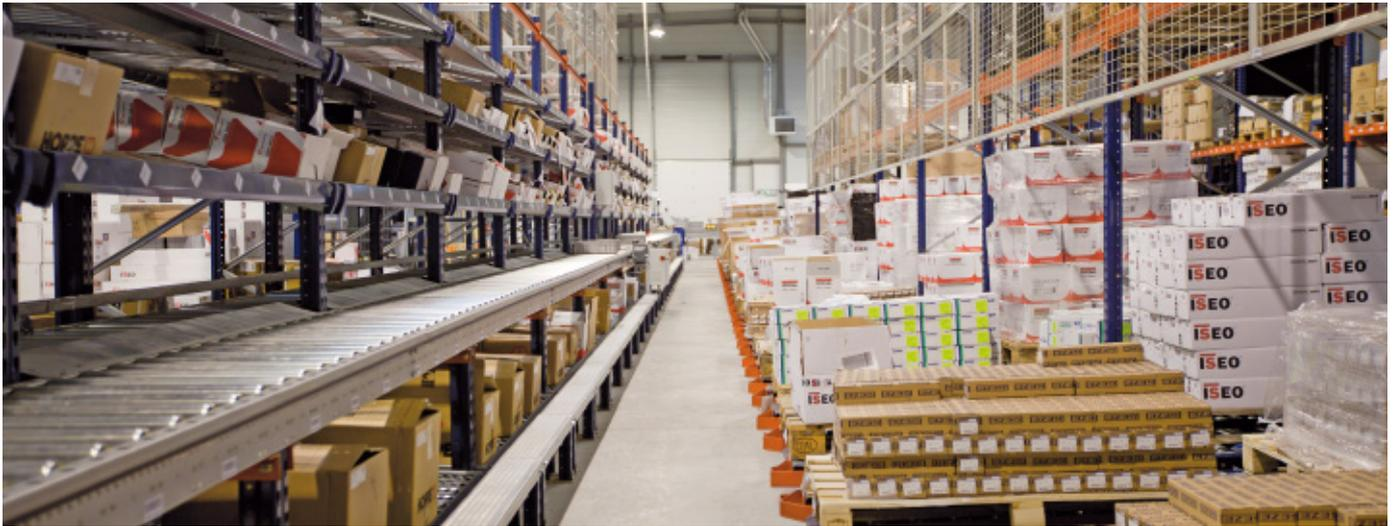
Der automatische Förderer durchläuft das Innere der Regalzeilen zwischen den Ebenen 1 und 2. An der Außenseite und parallel dazu wurde ein zweiter, freier Förderer installiert, der als Vorbereitungstisch dient. Wenn die Bestellungen vollständig sind, werden sie durch Anschieben in den ersten Förderer und zum Bereich der Klassifizierung/Kommissionierung verbracht. Die Kartons, die auf Paletten ankommen, werden ebenfalls in diesen Förderer verbracht.
